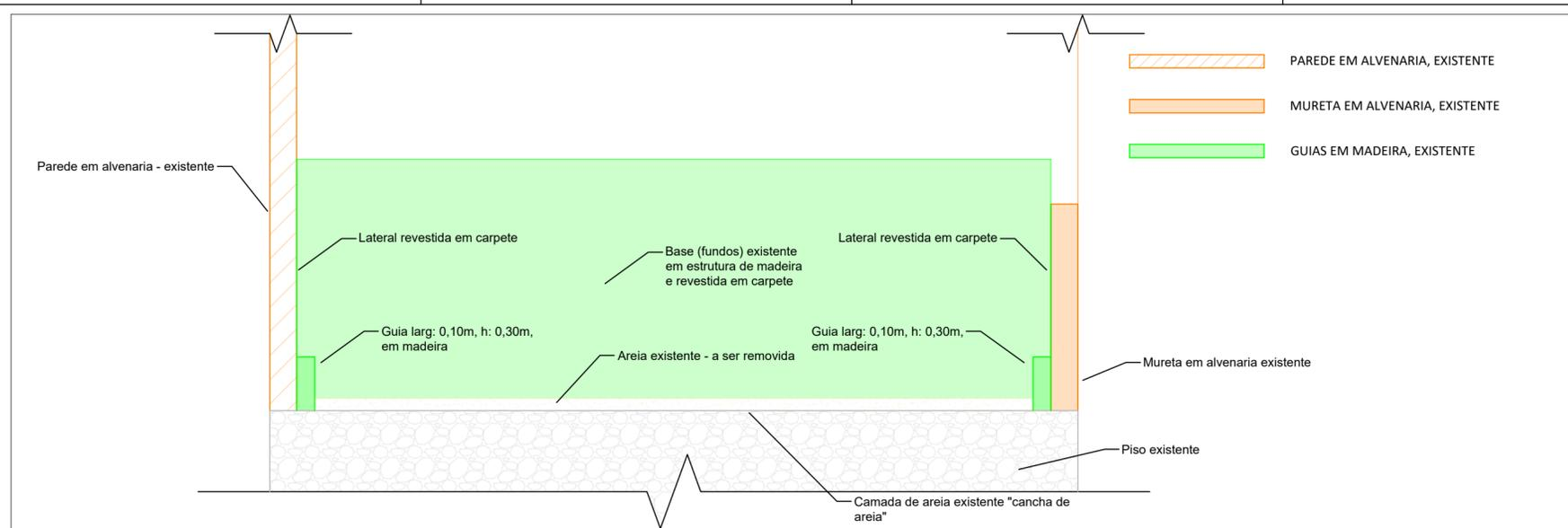
SEÇÃO TRANSVERSAL - CORTE AA - SITUAÇÃO EXISTENTE
