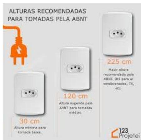
Para a alimentação dos equipamentos elétricos de uso geral foram previstas tomadas de força do tipo universal 2P+T (10/250V 60Hz).
