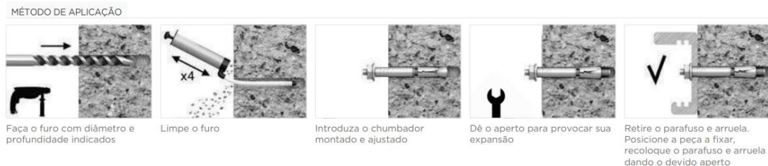
Figura 8 - Método de aplicação dos parafusos chumbadores
