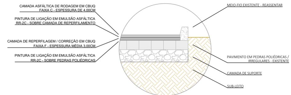
DETALHAMENTO - PAVIMENTAÇÃO SOBRE SUB-LEITO OU RECONSTRUÇÃO
