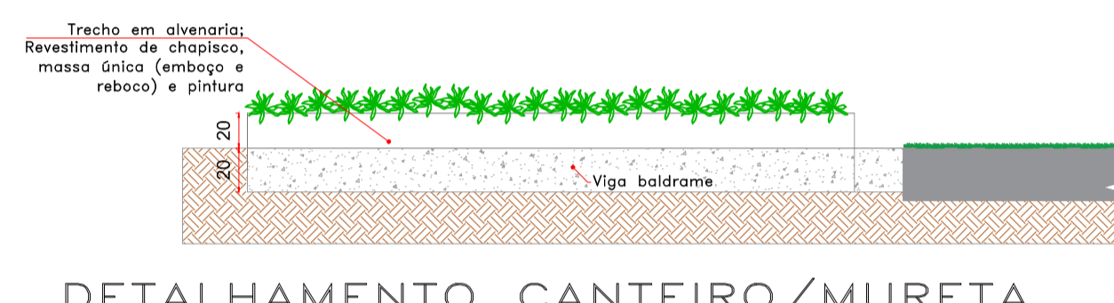
DETALHAMENTO CANTEIRO/MURETA SEM ESCALA
