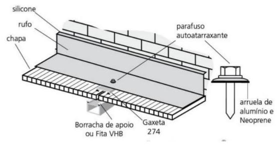
As distâncias entre os apoios serão definidas de acordo com a espessura da chapa (instalações planas) ou de acordo com o raio de curvatura (instalações curvas).
